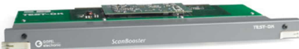
TEST-OK Expansion Board with Boundary Scan Funktionalität
